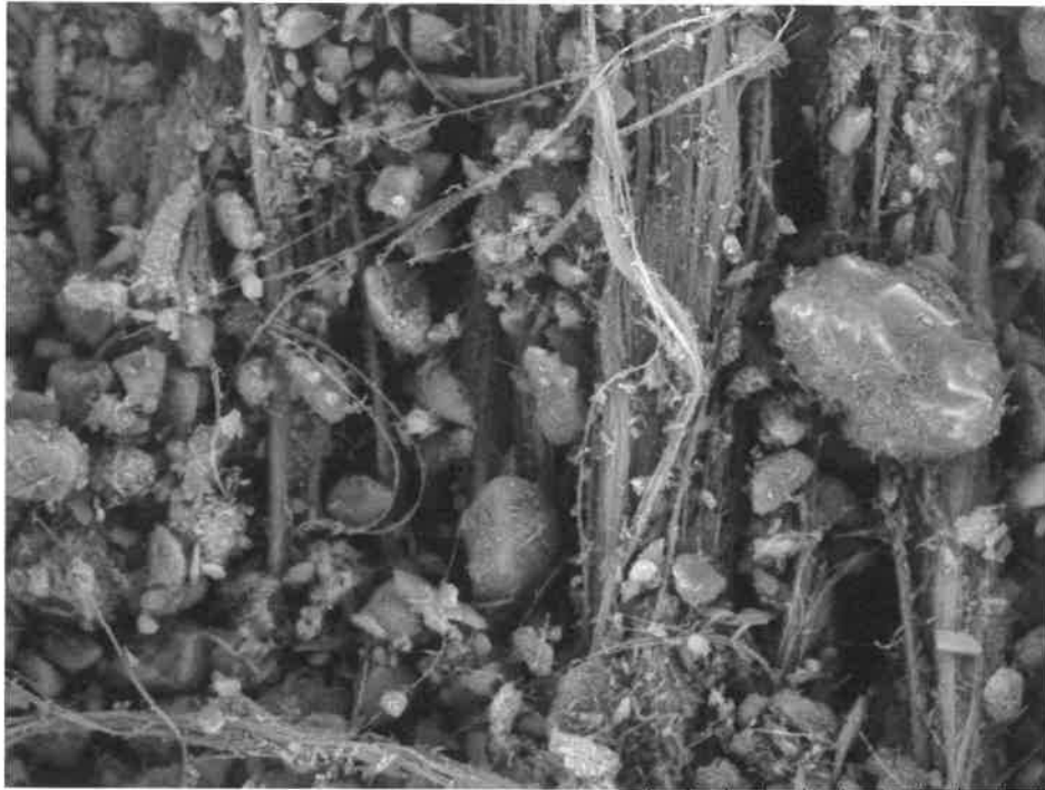
写真 15 SEM 写真：モルタル混和剤（倍率 2000 倍）
